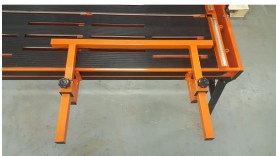
Die 2 Schenkel der Schnittführung in die Halter einschieben
