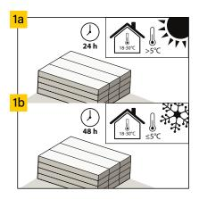
Nach einem Transport in der Temperatur >+5°C brauchen die Paneele vor der Verlegung eine 24-Stunden-Akklimatisierung bei 18 bis 30°C in einem Raum, der für die Verlegung vorgesehen ist. Bei Transport bzw. Lagerung beieiner Temperatur unter +5°C ist die Zeitdauer bis 48 Stunden zu verlängern.
