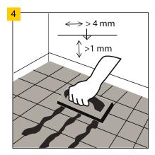
Bei der Verlegung auf keramischen Fliesen soll die Fugenbreite nicht mehr als 4 mm und die Tiefe nicht mehr als 1 mm betragen. Größere Abstände sind mit Harzmasse auszufüllen. Der Boden kann auf Fliesen mit Fugen mit einer Breite von bis zu 5 mm und einer Tiefe von 1 mm ohne deren Ausgleich verlegt werden, unter der Voraussetzung, dass die Unterlage Multiprotec Super Hardlay der Vinclic Super Solid verwendet wird.
