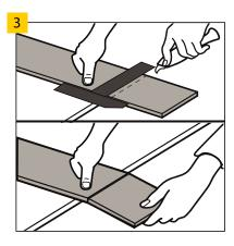
Verwenden Sie zum Zuschneiden der Bodenpaneele ein scharfes Messer, schneiden Sie die obere Schicht ein, danach knicken Sie energisch das Paneel nach unten weg. Die Bodenpaneele können auch mit einer elektrischen Säge zugeschnitten werden.
