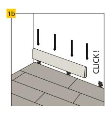
Dilatationen entlang den Wänden sollen mit passenden anhand von Klebstoff oder Klips montierten Sockelleisten zugedeckt werden. Wir empfehlen unsere Sockelleisten von Arbiton, die zu einzelnen Designbodendekoren passen und stoß- und kratzbeständig sind.
