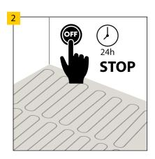
Schalten Sie vor der Installation das aus Fußbodenheizung für 24 Stunden.
