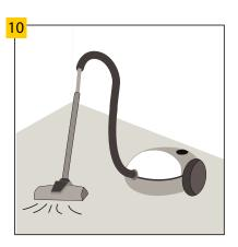
Stellen Sie sicher, dass der Untergrund trocken, flach, stabil und frei von Fett sowie chemischen Substanzen ist. Vor der Verlegung ist der Untergrund zu fegen und zu staubsaugen. Größere Beschädigungen und Risse sollen beseitigt werden.
