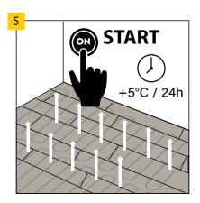
Nach der Verlegung und dem Ablauf von 24 Stunden kann die Fussbodenheizung eingeschaltet werden. Es ist zu beachten, dass die Temperatur langsam erhöht wird [5°C pro Tag].
