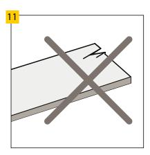
Vor und während der Verlegung sind sämtliche Paneele bei Tageslicht eingehend auf Beschädigungen und Materialfehler zu überprüfen. Paneele mit sichtbaren Mängeln oder Beschädigungen dürfen nicht verlegt
