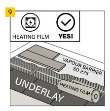
Die Verlegung auf einer Heizfolie ist ebenfalls zulässig, sofern eine dafür geeignete Unterlage und eine zusätzliche Dampfbremsfolie mit SD ≥75 verwendet werden. Das gesamte System besteht aus einer direkt auf den Untergrund verlegten Dampfbremsfolie, dann einer entsprechenden Unterlage (mind. 400 kPa, die empfohlene Dicke der Unterlage beträgt 5 mm), darüber einer Heizfolie, einer Dampfsperrfolie und dem Boden.
