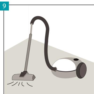
Stellen Sie sicher, dass der Untergrund trocken, flach, stabil und frei von Fett sowie chemischen Substanzen ist. Vor der Verlegung ist der Untergrund zu fegen und zu staubsaugen. Größere Beschädigungen und Risse sollen beseitigt werden.
