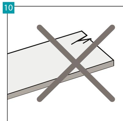
Vor und während der Verlegung sind sämtliche Paneele bei Tageslicht eingehend auf Beschädigungen und Materialfehler zu überprüfen. Paneele mit sichtbaren Mängeln oder Beschädigungen dürfen nicht verlegt werden.
