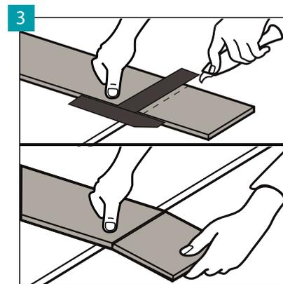
Verwenden Sie zum Zuschneiden der Bodenpaneele ein scharfes Messer, schneiden Sie die obere Schicht ein, danach knicken Sie energisch das Paneel nach unten weg. Die Bodenpaneele können auch mit einer elektrischen Säge zugeschnitten werden.
