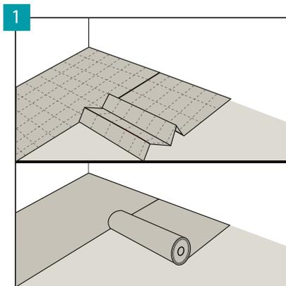
Verlegen Sie die Arbiton, Ewifoam oder Afirmax Unterlage quer zur Verlegerichtung der Paneele. Legen Sie die Nebenbahnen bündig aneinander an, lassen Sie sie überlappen oder verbinden Sie sie mit Kleband Arbiton AluTape. Vermeiden Sie Abstände.
