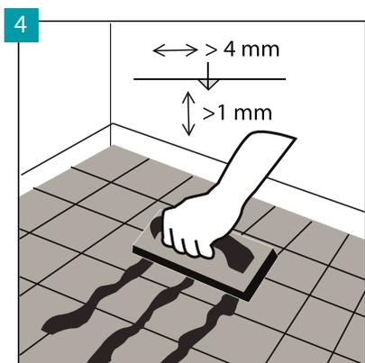
Bei der Verlegung auf keramischen Fliesen soll die Fugenbreite nicht mehr als 4 mm und die Tiefe nicht mehr als 1 mm betragen. Größere Abstände sind mit Harzmasse auszufüllen. Der Boden kann auf Fliesen mit Fugen mit einer Breite von bis zu 5 mm und einer Tiefe von 1 mm ohne deren Ausgleich verlegt werden, unter der Voraussetzung, dass die Unterlage Multiprotec Super Hardlay der Vinclis Super Solid verwendet wird.
