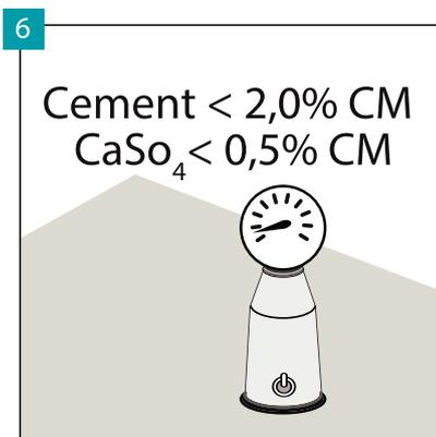
Beim Zementausgleich darf die Feuchtigkeit des Unterbodens 2,0% nicht überschreiten, und bei Anhydritmassen 0,5%. Bei der Verlegung über der Bodenheizung betragen die erforderlichen Werte jeweils 1,8% und 0,3%.
