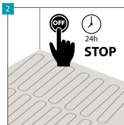
Schalten Sie vor der Installation das aus Fußbodenheizung für 24 Stunden.
