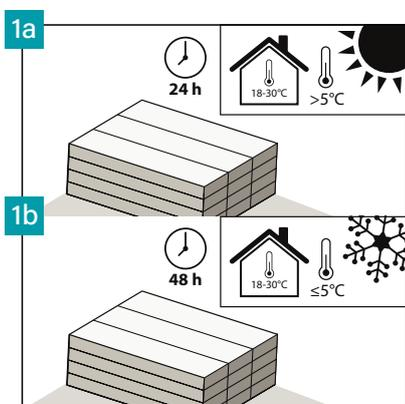
Nach einem Transport in der Temperatur  $>+5^{\circ}\text{C}$  brauchen die Paneele vor der Verlegung eine 24-Stunden-Akklimatisierung bei 18 bis  $30^{\circ}\text{C}$  in einem Raum, der für die Verlegung vorgesehen ist. Bei Transport bzw. Lagerung bei einer Temperatur unter  $+5^{\circ}\text{C}$  ist die Zeitdauer bis 48 Stunden zu verlängern.
