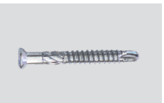
Bohrschraube 5,5x45 mm zur Befestigung von der Alu-UK mit Konterlattung
