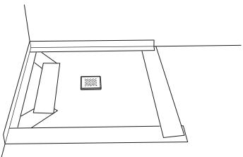
**12)** Der Rost (3) wird eingesetzt. Anschließend kann das Duschelement verfliest werden.
