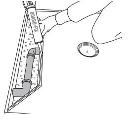
**6)** Der zum System gehörende Kleb- und Dichtstoff BOARD-FIX® (6) wird auf den Stufenfalz des Duschelementes strangförmig aufgetragen.
