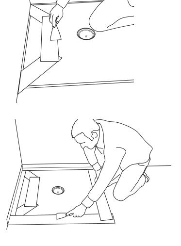
10) Zum Einsetzen des Geruchsverschlusses wird zunächst der Innenrand des Ablaufes eingefettet.
