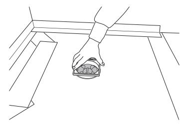
11) Je nach Fliesendicke wird das Aufsatzstück (4) auf die passende Länge gekürzt und eingesetzt.
