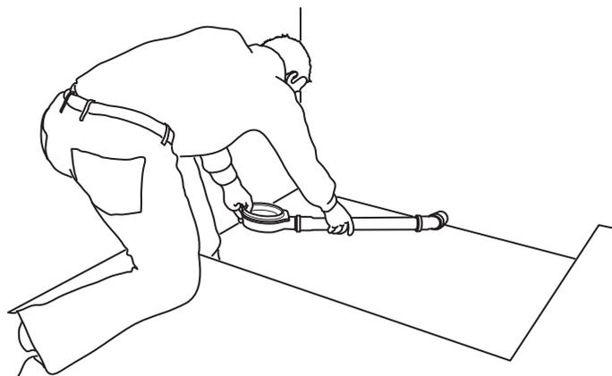
3) Die Bodenaussparung wird mit einem Ausgleichs-estrich ausgefüllt und eben abgezogen. Es muss eine ebene und waagerechte Fläche entstehen. Der Höhenversatz zum Estrich ergibt sich aus der Dicke des Duschelementes (60, 70, bzw. 80 mm) + ca. 5 mm Fliesenkleber. Der Bodenablauf muss mit dem Mörtel fest verbunden sein, um Lasteinwirkungen aufnehmen zu können.
