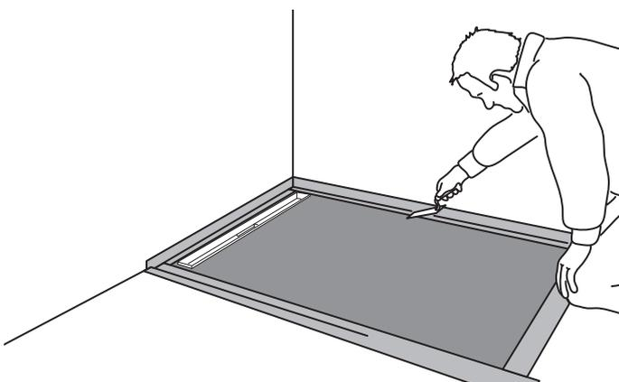
8) Alle Anschlussfugen werden mit dem JACKOBOARD® Abdichtungset (oder gleichwertig) abgedichtet.
