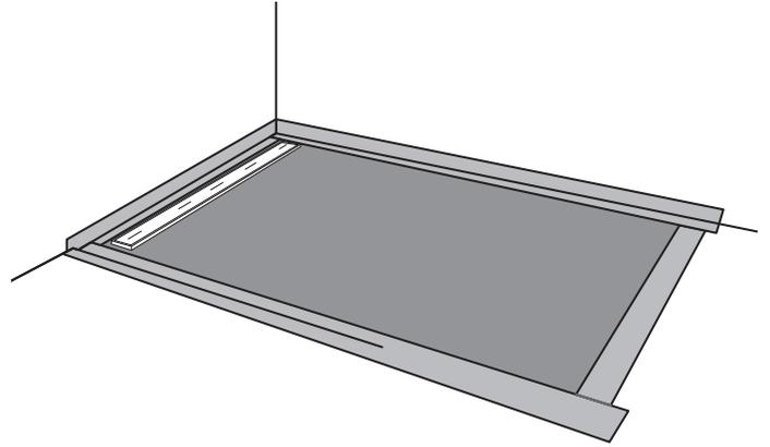
10) Die Rinne ist in der Höhe variabel und kann an unterschiedlichen Fliesendicken (6–21 mm) angepasst werden. Die Höhenjustierung wird an den roten Schrauben mit einem Schlitzschraubendreher vorgenommen.
