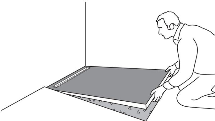
7) JACKOBOARD® Aqua Line pro wird in die Estrichausparung eingesetzt, so dass der Ablaufstutzen der Rinne in den Dichtring des Ablaufes gleitet.
