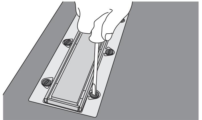
11) Die Einlegeschiene aus Edelstahl ist auf der Rückseite verfliesbar. Hierzu einfach wenden und verfliesen.
