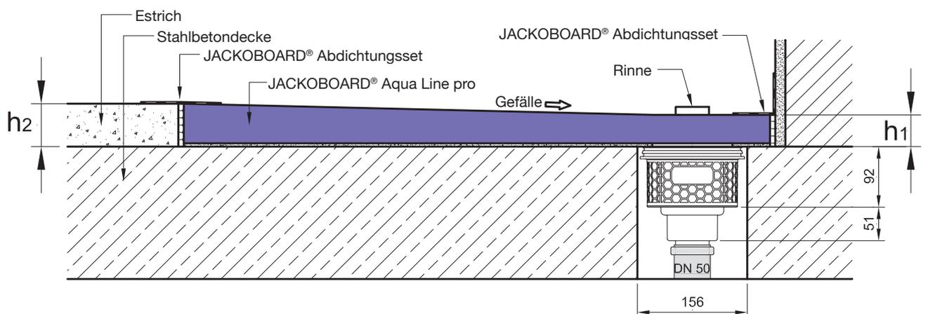
$h_1 = 48 \text{ mm} = \text{Duschelementdicke (43 mm) + 5 mm Klebemörtel (mind. Auhöhe im Bereich der Rinne)}$
