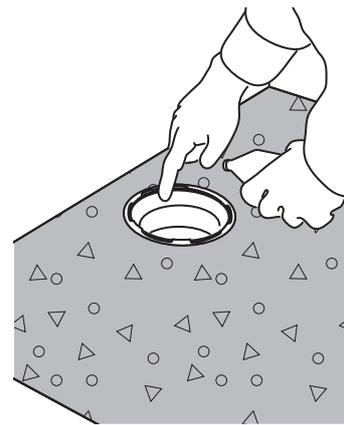
6) Fliesenkleber wird vollflächig auf die Unterseite des Duschelementes aufgetragen.
