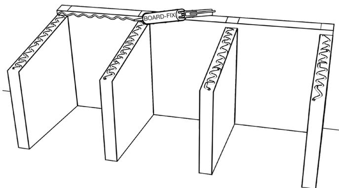
7) Auf den Stützwänden A und auf der Unterseite der Abdeckung B1 wird BOARD-FIX® aufgetragen.
