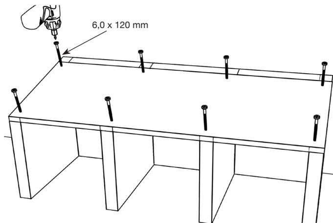
8) Die Abdeckung B2 wird aufgeklebt und angeschraubt.
