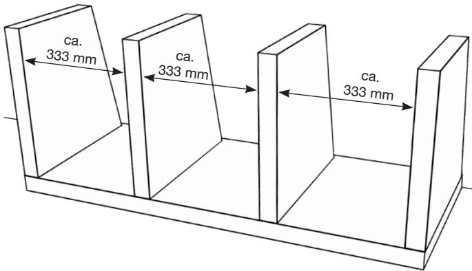
1) Auf die Unterseite der Abdeckung B1 werden die Stützwände A im gleichen Abstand aufgestellt ...
