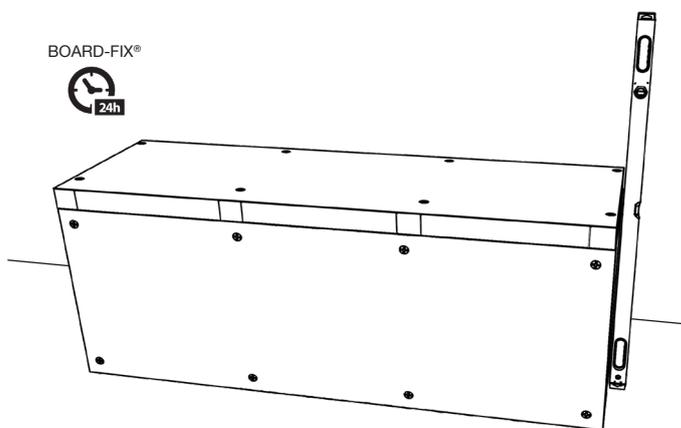
10) Die Sitzbank wird an Wand und Boden angeklebt, so dass sie lotrecht positioniert ist.
