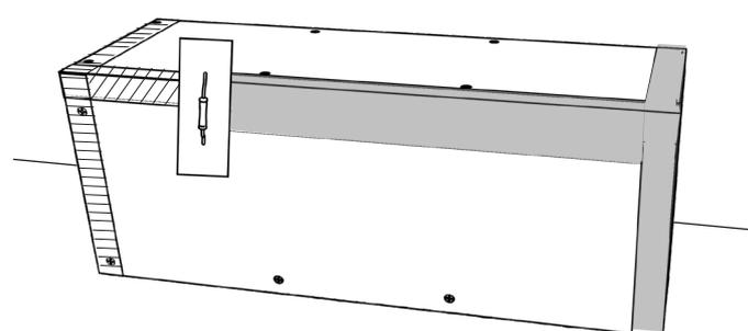
12) Das Armierband wird mit Fliesenkleber überge-spachtelt. Die Sitzbank ist jetzt fertig und kann verfliest werden.
