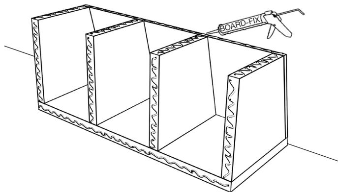
9) Die Sitzbank muss an der Wand und am Boden angeklebt werden. Hierzu wird BOARD-FIX® auf die Stirnflächen der Rückseite und Unterseite aufgetragen.
