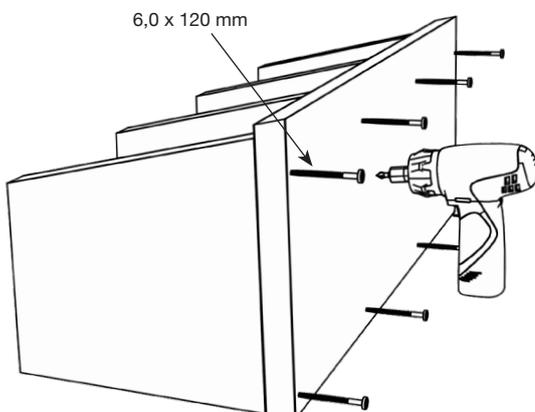
5) Die Stützwände A werden angeschraubt.
