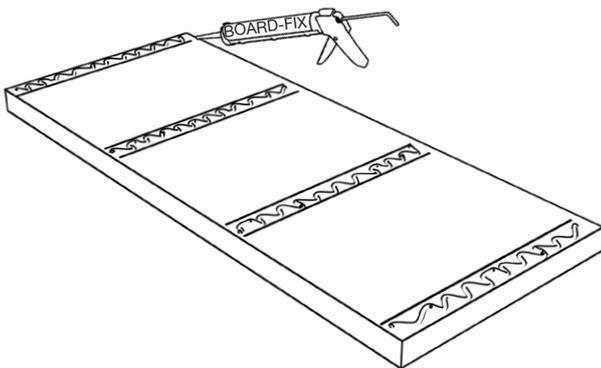
3) Entsprechend den angezeichneten Umrissen wird BOARD-FIX® aufgetragen.
