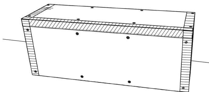
11) Alle Stoßfugen und sichtbaren Stirnkanten werden mit dem selbstklebenden JACKOBOARD® Armierband abgeklebt.
