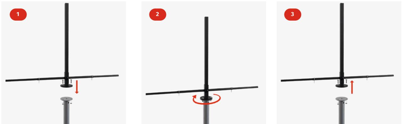
**1. Verbinden Sie das Werkzeug mit der Scheibe der Fundamentschraube** mit Hilfe der 3 mitgelieferten Muttern.
