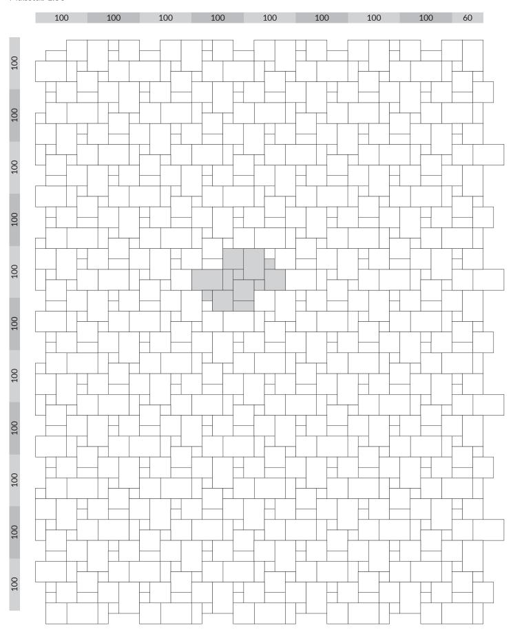
$20er \ Raster, Verlegung \ mit \ 5 \ Formaten \ (60,9 \times 60,9 \ cm \ | \ 40,6 \times 60,9 \ cm \ | \ 40,6 \times 40,6 \ cm \ | \ 20,3 \times 40,6 \ cm \ | \ 20,3 \times 20,3 \ cm)$  Maßstab 1:50
